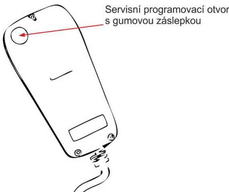
Na zadní straně ovládací jednotky je umístěn otvor s gumovou záslepkou, který je určen výhradně k servisním účelům. Tímto způsobem smí do zařízení zasáhnout pouze proškolený pracovník.
