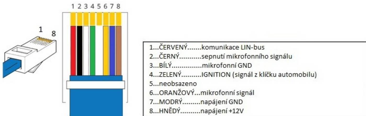
Obr. 4: Náskres konektoru s popisem pinů a signálů
